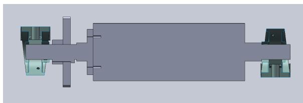
图 5: 碾压辊轮内部剖面示意图
